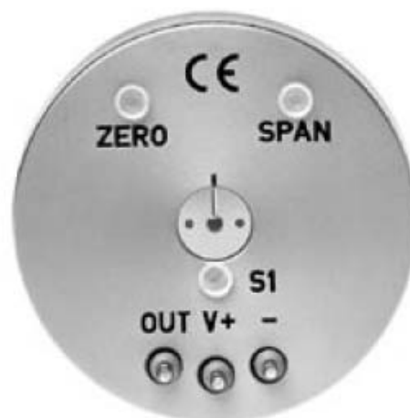
带电连结和零点、量程电位器的后视图。
